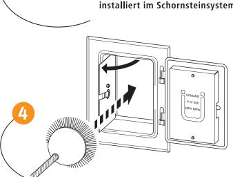
Rußschutztür geöffnet, Kehrgerät lässt sich einsetzen; danach wird die Tür durch Drehen des Riegels nach rechts geschlossen (siehe Bild 5)
